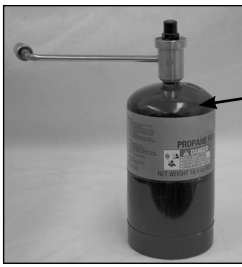
test de fuite
